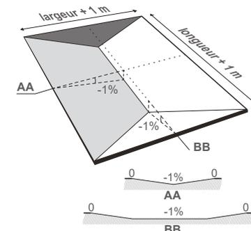
Sol propre et stabilisé + lit de sable (0/2) 10 cm (+/- 2 cm)
