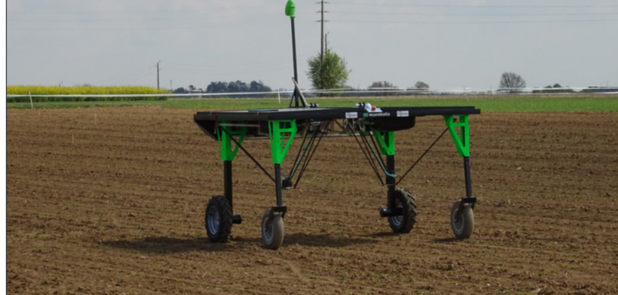
Exemple de robot "Ecorobotix ®" pour le désherbage ciblé sur betterave
