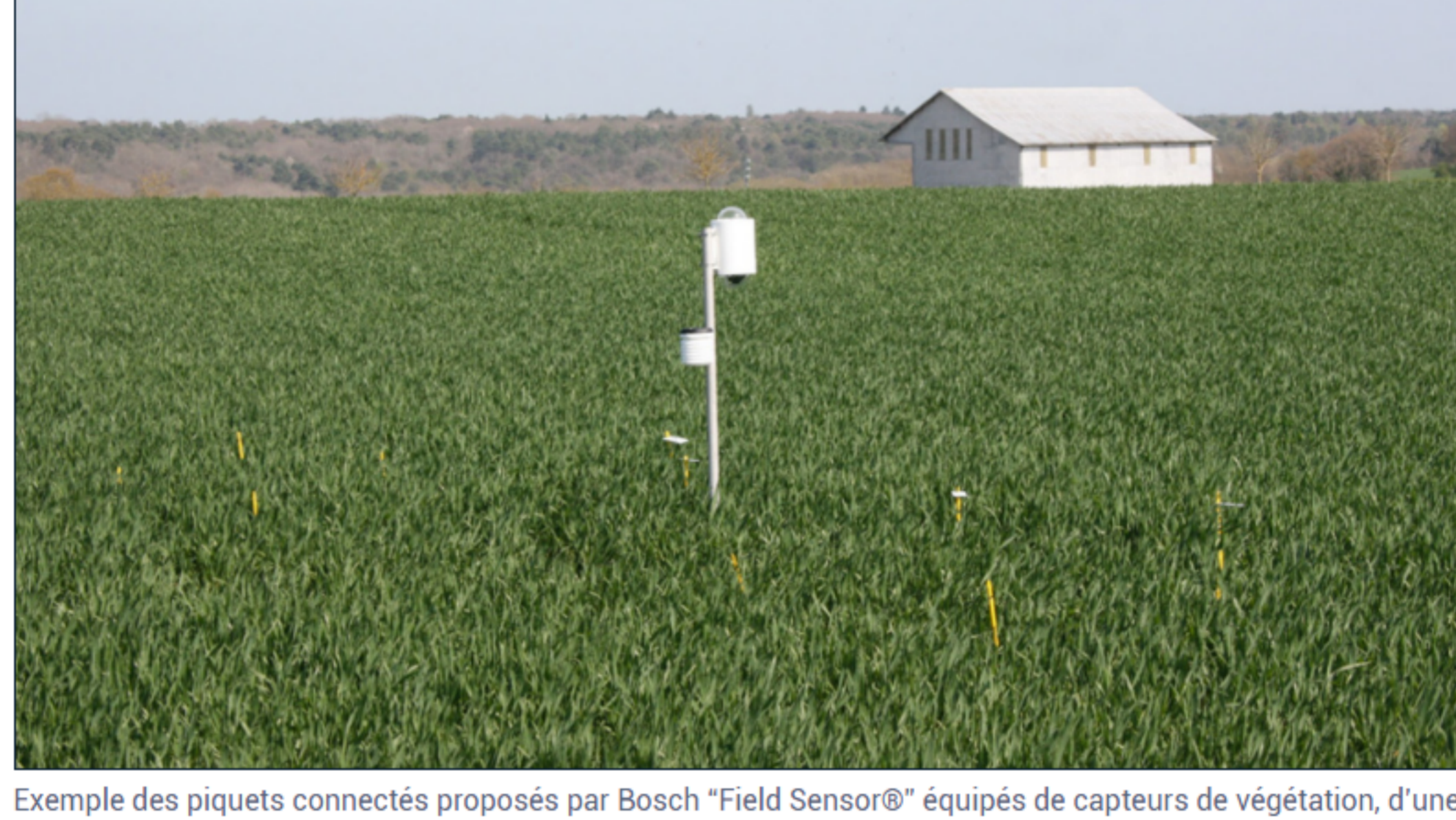
Exemple des piquets connectés proposés par Bosch "Field Sensor®" équipés de capteurs de végétation, d'une station météo et d'une station au sol
